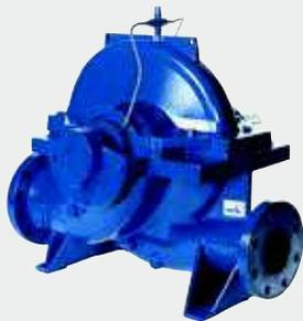
Pompa monostadio, a divisione assiale per installazione orizzontale o verticale con girante radiale a doppio ingresso, flange in accordo a DIN, ISO, BS e ANSI.
