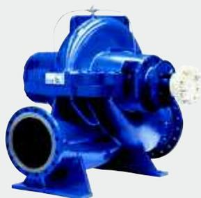
Pompa monostadio, a divisione assiale per installazione orizzontale o verticale con girante radiale a doppio ingresso, flange in accordo a DIN, ISO, BS e ANSI.
