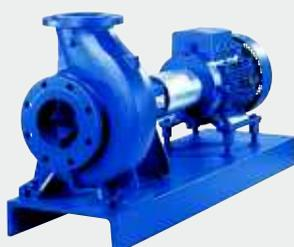
Pompa orizzontale, a singolo stadio con corpo a spirale su basamento, a partire dalla grandezza 125 anche con due stadi in esecuzione back pull-out. Camicie dell'albero e anelli di usura corpo sostituibili.
